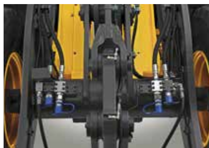
Circuits hydrauliques auxiliaires 1 et 2
