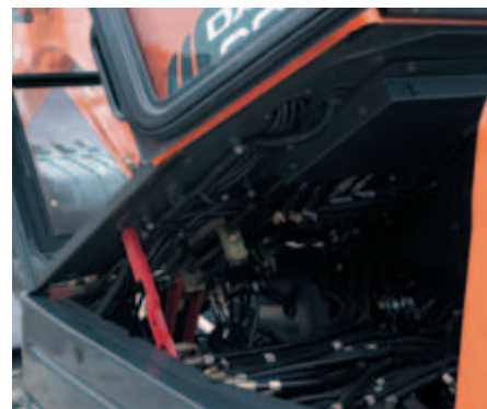
Cabine basculante pour faciliter l'entretien
