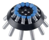
Rotor angulaire | GLK030 15 mL×12 6000 rpm / 5150 ×g
