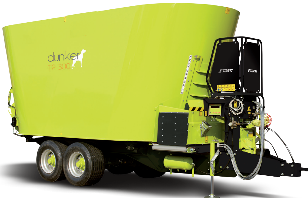
Maschine mit Querförderband vorne und Bowdenzug-Bedienung Ausrüstung
