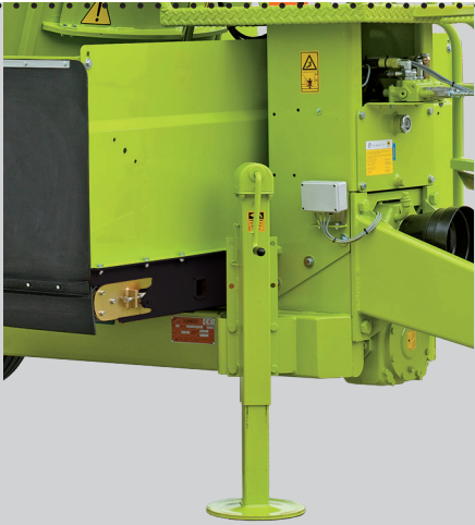
Mechanischer Stützfuß Béquille manuelle Mechanische steunpoot
