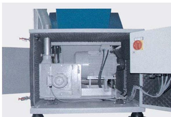
Machine ouverte avec ventilateur de vidange intégré
