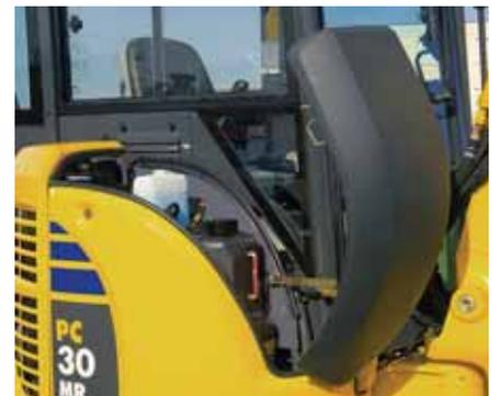
Capot avant: accès aisé au réservoir de carburant
