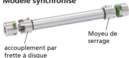
Si les impératifs de construction requièrent une longueur de montage supérieure à la longueur de montage max. ou à la vitesse de rotation max. calculée à l'aide de la formule « Détermination du dimensionnement de l'arbre » (voir ci-dessous), il faut utiliser un support de palier pour absorber les charges correspondantes.
