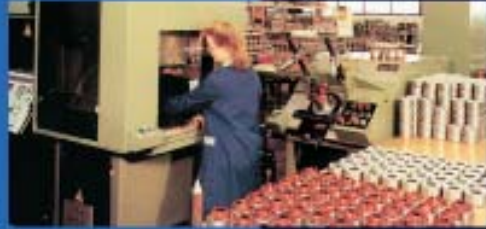
USINE - SECTION BOBINAGE DES STATORS
