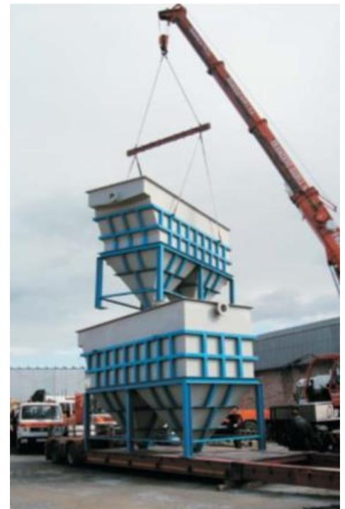
**HORUS** élargit sa gamme traditionnelle de décanteurs lamellaires préfabriqués d'une nouvelle série spécialement dédiée à l'exportation.
