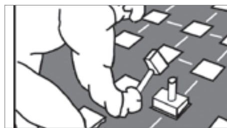
Encastrement des plaquettes dans l'isolant
