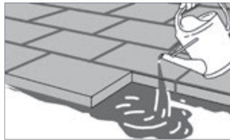
Mise en œuvre du bitume chaud (EAC) à l'arrosoir
