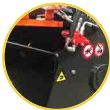
Kit d'ouverture de la grille de protection manuel composé d'une poignée avec crochet, amortisseurs à gaz et blocage hydraulique de la vis
