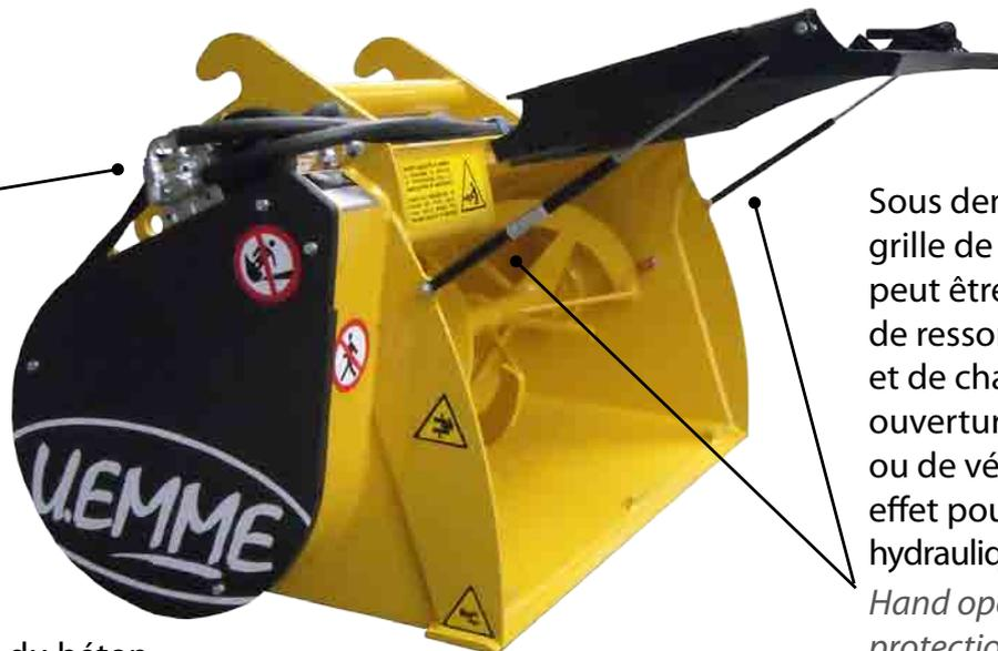
Sous demande la grille de protection peut être équipée de ressorts à gaz et de charnières à ouverture manuelle ou de vérins à double effet pour l'ouverture hydraulique
