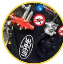
Kit d'ouverture de la grille de protection hydraulique composé de vérins à double effet et de système de blocage hydraulique de la vis
