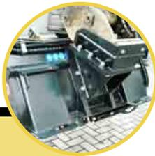
Différents types d'accrochage. Dans la photo double accrochage mini-chargeur /attache rapide pour pelle
