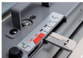
Réglage de profondeur de rainage selon le type de papier
