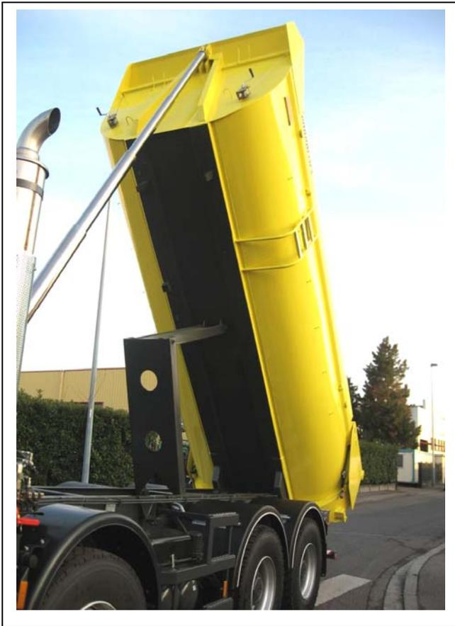
3 – **Vérin télescopique frontal** (compas stabilisateur mécanique en option)
