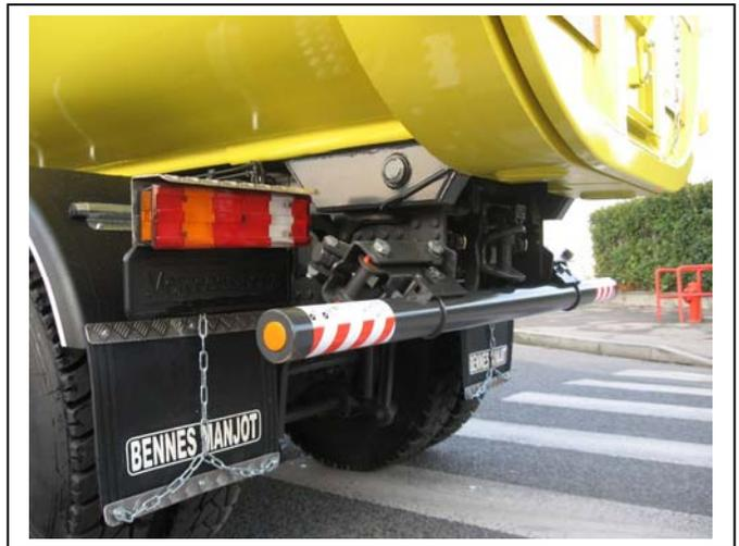
5 – **Compatibilité au finisseur** avec barre anti-encastrement appropriée
