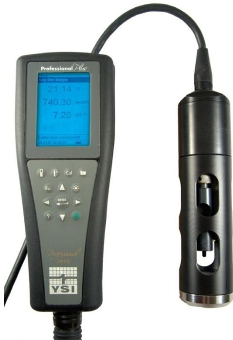
Le **ProPlus** utilise l'un des câbles support équipé de connexions permettant de mesurer et enregistrer en simultané : température, conductivité, oxygène dissous, électrodes ISE : pH, redox, ammonium, nitrates ou chlorures. Le câble détermine la combinaison possible.
