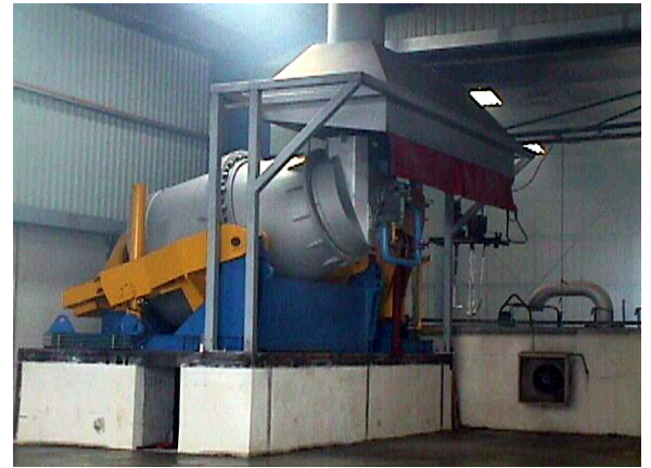
Vaste hotte d'assainissement Mono Bandage de roulement Entraînement par couronne dentée
