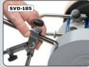
**Dispositif pour gouges**
