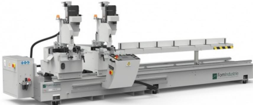
**Tronçonneuse à deux têtes à lame descendante pour profilés en fer avec déplacement motorisé de la tête mobile et positionnement électropneumatique de l'axe vertical**
