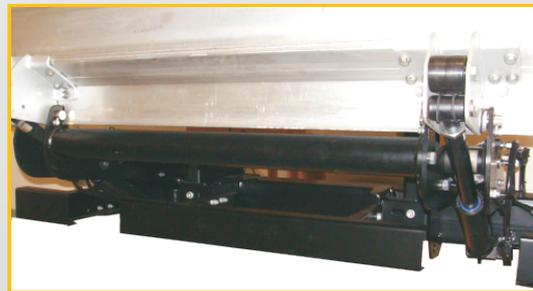
Barre de torsion montée haut et réglable, barre anti-encastrement solide et ajustable
