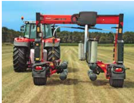
L'enrubanneuse passe d'une largeur de transport repliée de 2,50 m à une largeur de 4 m au travail
