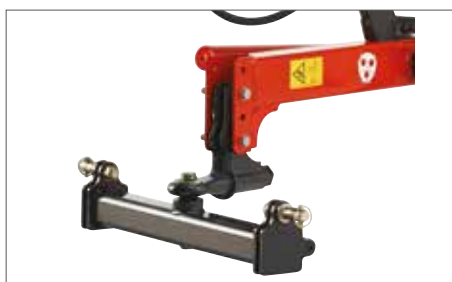
La longue barre d'attelage permet d'associer aisément les côtés de l'enrubanneuse à de grands / larges tracteurs
