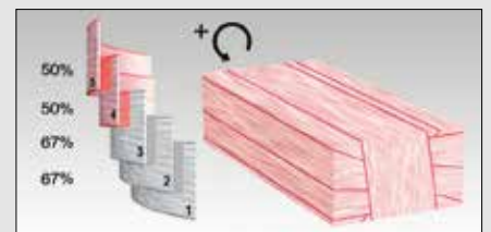
Application des 2 dernières couches avec 50 % de recouvrement
