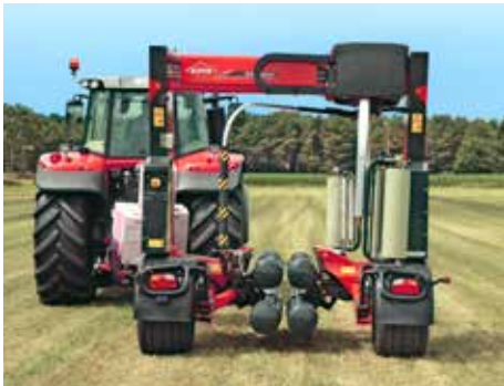
L'enrubanneuse passe d'une largeur de transport repliée de 2,50 m à une largeur de 4 m au travail
