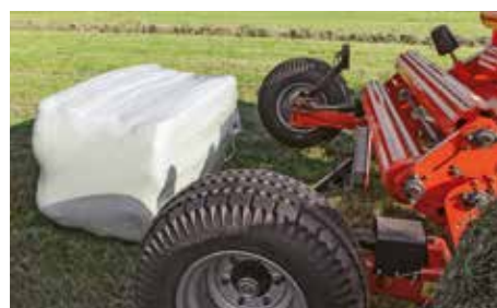
De faible hauteur, la table permet un basculement en douceur de la balle afin d'éviter tout endommagement du film
