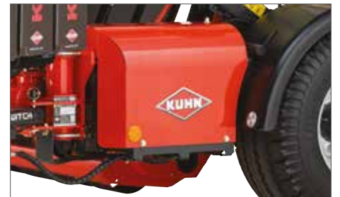
Un grand capot latéral protège l'unité hydraulique et offre une excellente accessibilité pour la maintenance de la machine
