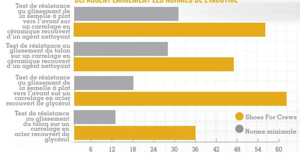
Test EN ISO 13287:2012 pour déterminer la résistance au glissement, effectué par TÜV Rheinland LGA Products GmbH à Leipzig, en Allemagne, en août 2018. \* Sur une échelle où 0,0 correspond à l'absence de friction et 1,0 correspond à une très forte friction (par ex. un tapis sec), SFC a enregistré 0,63, soit plus de trois fois la norme minimale de 0,18. Toutes les chaussures SFC sont équipées de la semelle extérieure antidérapante brevetée Shoes For Crews. Produit testé: DDLCE81 76236
