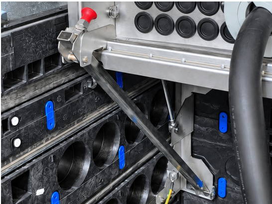
Système de blocage (ouvert) du coffret
