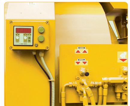
\*Système de pesage basé sur cellule de charge
