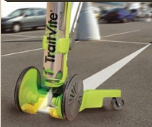
L'Aérosol Epoxy Traitvite Rocol est une peinture ester époxydique, conditionnée sous forme d'aérosol. Il permet le traçage et le marquage sur surfaces cimentées, époxydique, goudron, macadam, bitume et autres revêtements routiers. Il convient également sur d'autres surfaces préalablement dégraissées comme le métal, le bois, etc. Il a été spécialement formulé pour répondre aux plus fortes exigences.
