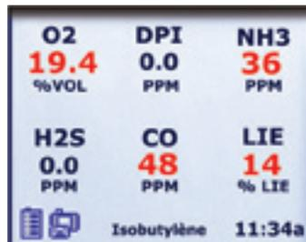
Des chiffres en rouge vif et un panneau lumineux clignotant signalent les conditions d'alarme.
