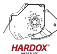
DOUBLE CHASSIS INTERNE + CONTRE COUTEAUX EN HARDOX
