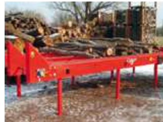
Deck à chaîne 10m + démêleurs rotatifs en étoile
