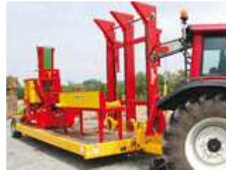
Plateau de transport "pose à terre" + deck à chaîne 3 m
