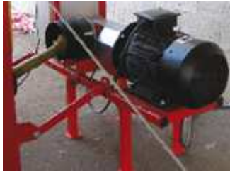
Entraînement électrique 18 KW - 45 A mini.
