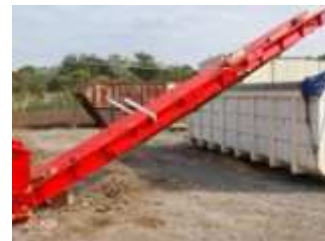
Tapis d'évacuation rallongé : 6m + orientation hydraulique
