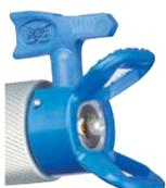
**Les buses Reverse-A-Clean® (RAC®)** sont l'idéal pour pulvériser une large gamme de revêtements. Pour un nettoyage rapide avec un temps d'arrêt minimum, tournez simplement la buse réversible sur la position de nettoyage et déclenchez le pistolet.
