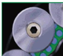
Lors de l'utilisation des disque-lames, seul un tiers de la circonférence est utilisé (voir illustration) permettant donc de tourner la lame jusqu'au tiers suivant lorsque la section actuelle perd de son efficacité. Les lames peuvent être tournées 3 fois avant l'affûtage
