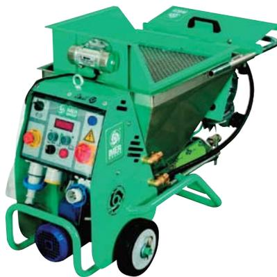
Inversion automatique de la machine à chaque arrêt pour décharger la pression à l'intérieur de la lance et des tuyaux
