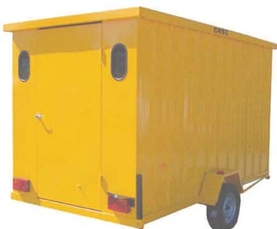
Panneaux et toiture en acier galvanisé nervuré
