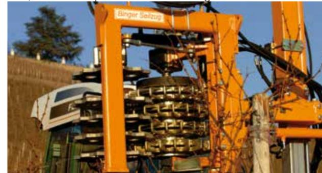
Le régime des disques ameneurs et des cages est soumis à un réglage indépendant qui permet de l'adapter à la vitesse d'avancement du véhicule.
