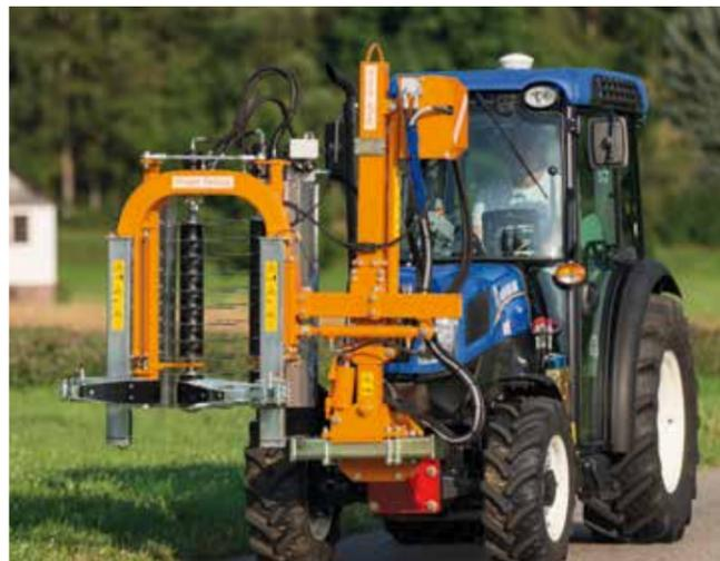
L'ajout et le retrait de disques est extrêmement rapide. Raison pour laquelle la VSL 07 P est aussi bien adaptée à la conduite en cordon qu'à la conduite en Guyot. Un châssis plus long ménageant un espace libre de 22 cm au-dessus de la scie supérieure est disponible en option. Son faible poids lui permet d'intervenir dans les vignobles pentus ou de configuration difficile.
