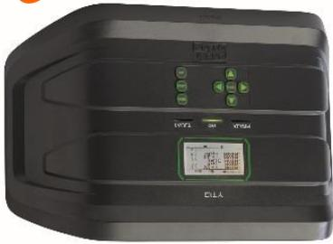
La centrale CITY CE408, aussi bien dans sa version murale que dans sa version rack, est équipée de 4 voies (4 sondes) de détection GAZ et 5 sorties relais (4 relais pour les asservissements et 1 pour dérangement et 1 entrée logique. Cette centrale est extensible à 8 voies (8 sondes), en ajoutant 1 carte d'extension des entrées sondes ES404 (4 voies supplémentaires) et 9 sorties relais, en ajoutant 1 carte de sorties relais ES 414 (4 relais pour les asservissements)
