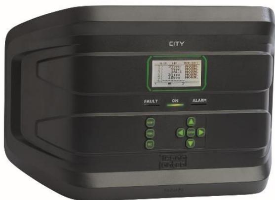
Les nouvelles centrales de la série CITY sont gérées par microprocesseur et destinées aux petites et moyennes installations d'usage industriel et tertiaire. Les centrales CITY disposent de **4 entrées** et de **5 relais** (extensibles à 8 entrées et 9 relais) pour le raccordement de toutes les sondes des séries SE / TS et IR destinées à la détection de gaz et vapeurs explosives, toxiques ainsi qu'à l'oxygène et au CO<sup>2</sup>.
