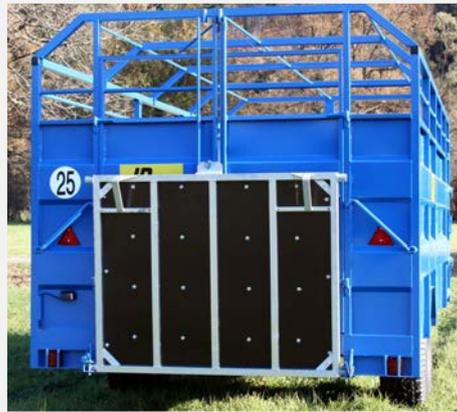
Pont arrière repliable et coulissant
