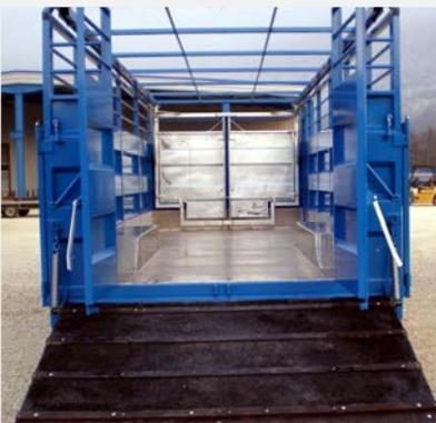
Plancher alu, barrière intérieure sur rail, pont arrière sur toute la largeur avec 2 ressorts
