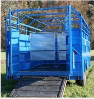
Barrière intérieure 2 positions + plancher caoutchouc
