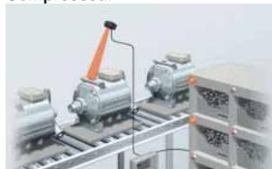
Fourniture d'instructions destinées à prélever les pièces nécessaires à l'assemblage d'un compresseur.
