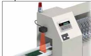
Le DV-90 assurera la différenciation des produits et fournira des instructions précises aux appareils (de contrôle) situés en amont.
