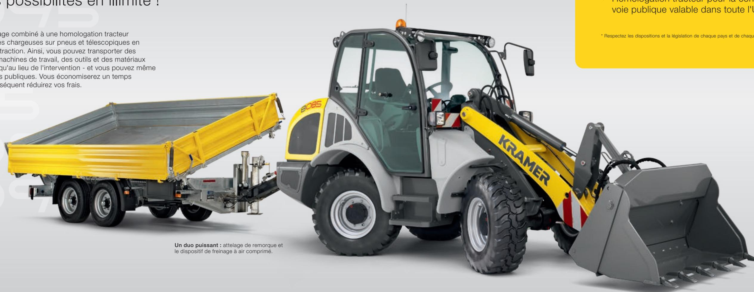
Un duo puissant : attelage de remorque et le dispositif de freinage à air comprimé.
