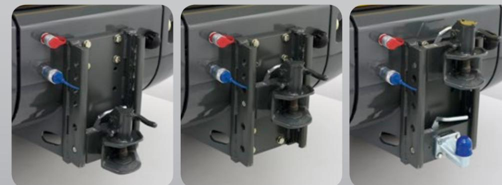
Adapté à différentes utilisations : La hauteur du dispositif d'attelage peut être facilement ajustée.
