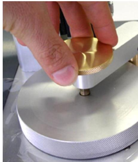
MultiPerm è conforme alle norme DIN 53380-3 e ASTM F2622 per la misura di O<sub>2</sub>TR, alla norma ASTM F2476 per le misure di CO<sub>2</sub>TR ed alla norma ASTM F1249 per le misure di WVTR.
