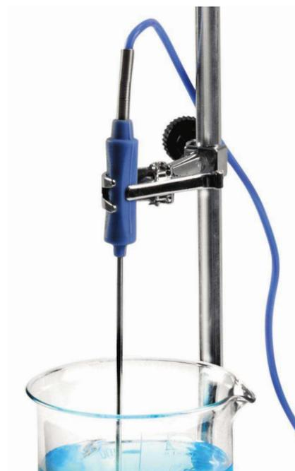
**Sonde de température Pt 100.** Permet la régulation de la température pour les agitateurs avec régulation digitale.
