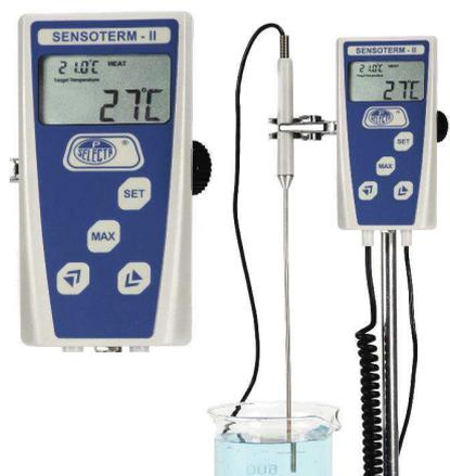
**Thermomètre à contact électronique avec lecture digitale "Sensoterm II".**
