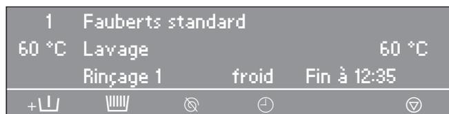
Lorsque le bloc de programme Prélavage est terminé, le bloc de programme lavage est affiché à la deuxième ligne avec la température actuelle du bain lessiviel. Le bloc de programme suivant est indiqué en-dessous, hier Rinçage 1.
