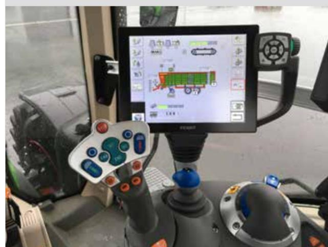
Grâce à la compatibilité du système de commande ISOBUS de Strautmann (certification ISOBUS AEF), différents terminaux peuvent être utilisés pour les autochargeuses Strautmann. Selon le type de tracteur, toutes les fonctions de la machine peuvent également être commandées par le joystick du tracteur.
