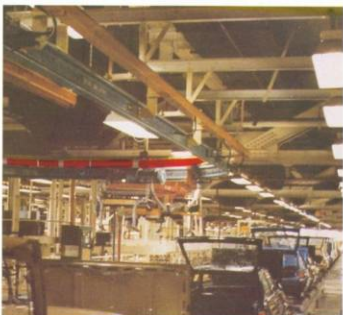
6. Hall d'assemblage de Ford. Entreprise à travail continu exige une sécurité du travail donc multiconductor.
