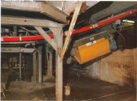
10. Palan à benne dans l'industrie bétonnière. Alimentation sûre - Multiconductor avec bousier d'étanchéité.
