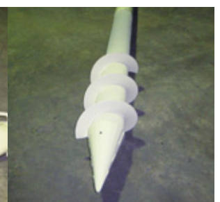
Aérateur, partie à visser dans les tas de grains
