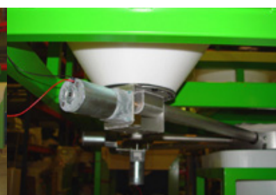
Trémies rotomoulées 50L avec vis de micro dosage
