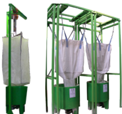
Distri-Maïs désilage de maïs humide vers mélangeur TOY
