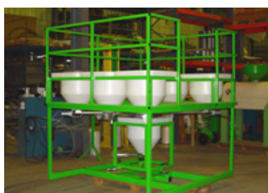
Trémies rotomoulées 50L sur châssis. Pesage 10gr
