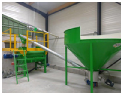
Distri-Maïs désilage de maïs humide vers mélangeur TOY
