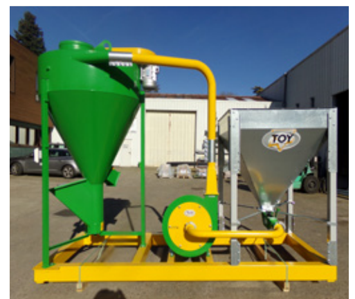
Trémie à céréales sur fabrique d'aliments Multi-Éco vertical
