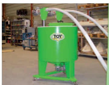
Trémie 250L. Alimentation mécanique. Pesage 100gr
