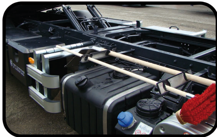
* Equipements carte blanche avec bac à sable, gilets, cônes, pelle, balai, extincteurs
