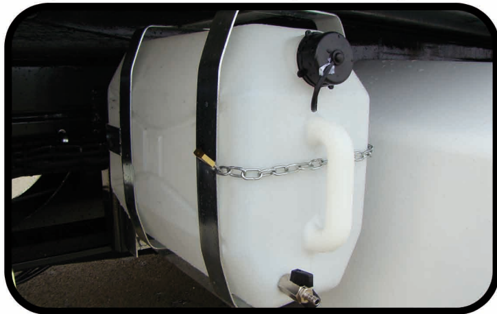
* Réservoir lave mains
