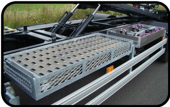
* Rampes manuelles en alu longueur 1200 mm adaptables par emboîtement dans les trous de cales
