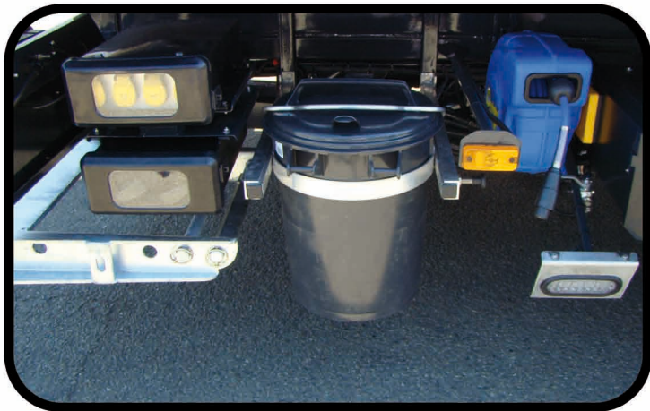
* Enrouleur pneumatique, bac à sable coulissant, extincteur dans un coffre de rangement
