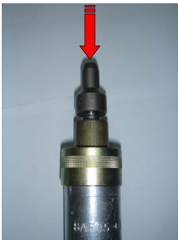
Fig 5.6 : Mise en place du poinçon
