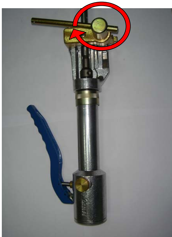
Fig 5.11 : Serrage de la machoire
