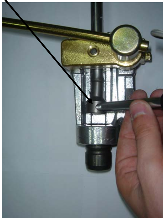
Fig 6.3 : Vissage de l'extracteur
