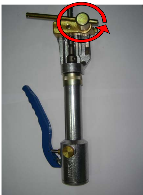
Fig 5.15 : Déserrage de la mâchoire
