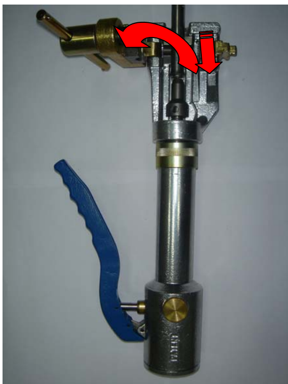
Fig 5.16 : Ouverture du système de blocage
