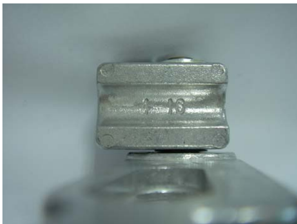
Fig 3.5 : Contre matrice pour tubes de diamètre 4 à 16 mm Fig 3.6 : Contre matrice pour tubes de diamètre 18 à 22mm
