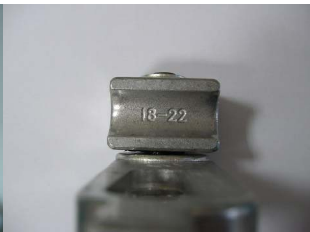
Fig 3.5 : Contre matrice pour tubes de diamètre 4 à 16 mm Fig 3.6 : Contre matrice pour tubes de diamètre 18 à 22mm
