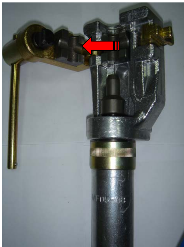
Fig 5.3 : Mâchoire et verrouillage de l'étai
