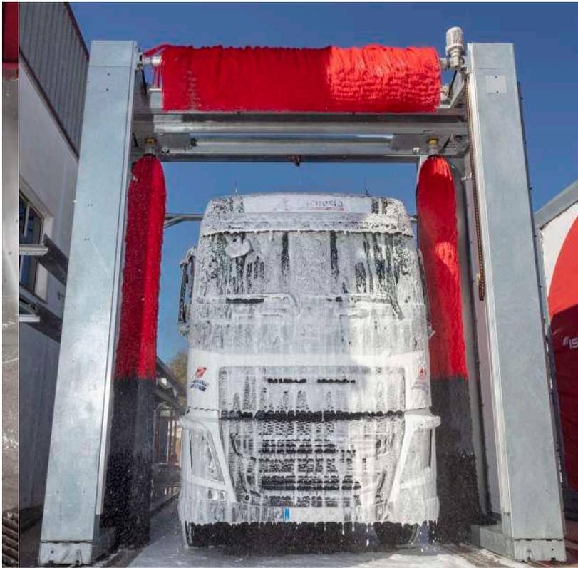
Le prélavage chimique moussant garantit une grande qualité de lavage des véhicules. Son application permet de nettoyer rapidement et très efficacement le film routier ainsi que les salissures les plus tenaces. Cette option comprend des tubes en acier inoxydable et des moussers pour le mélange avec l'air, une pompe électrique pour le dosage automatique et une pompe haute pression de 160 bar et 21 L/min à haute résistance chimique.
