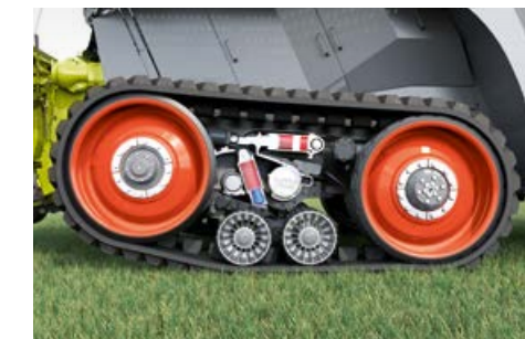
Surface de contact au sol réduite de 66 %
