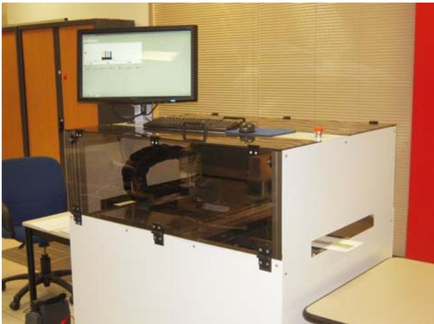
Le PrintNod 400 est un système d'impression jet d'encre couleur destiné à être installé en sortie de tous les types de machines de mise sous pli.
