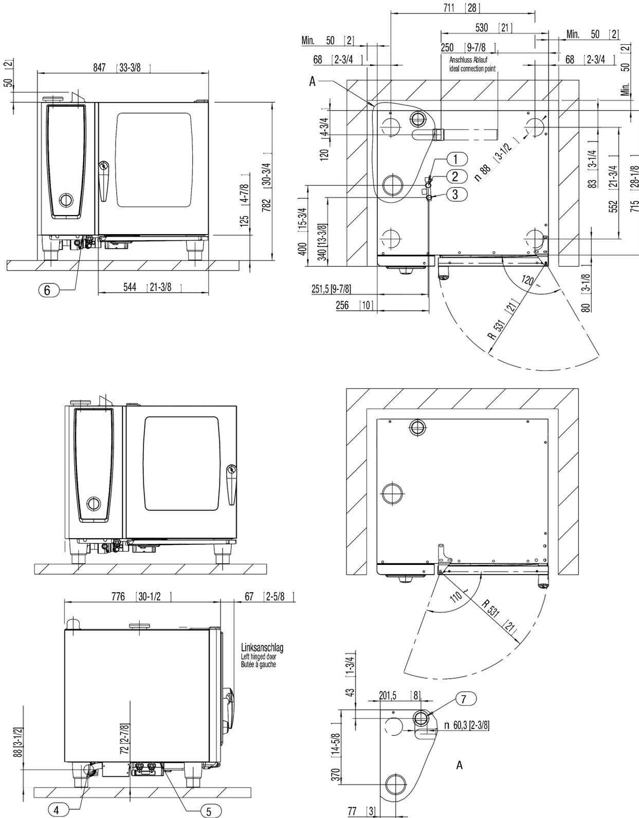
1. Alimentation commune en eau (eau froide) 2. Alimentation en eau froide 3. Alimentation en eau douce ou chaude 4. Raccordement électrique 5. Liaison équipotentielle 6. Tuyau de ventilation 2 3/8" / 60mm 7. Écart minimum 2" / 50 mm Pour pouvoir effectuer sans difficulté les travaux de service, nous recommandons un écart de 20" / 500 mm du côté gauche de l'appareil Mesures en mm (pouces)
