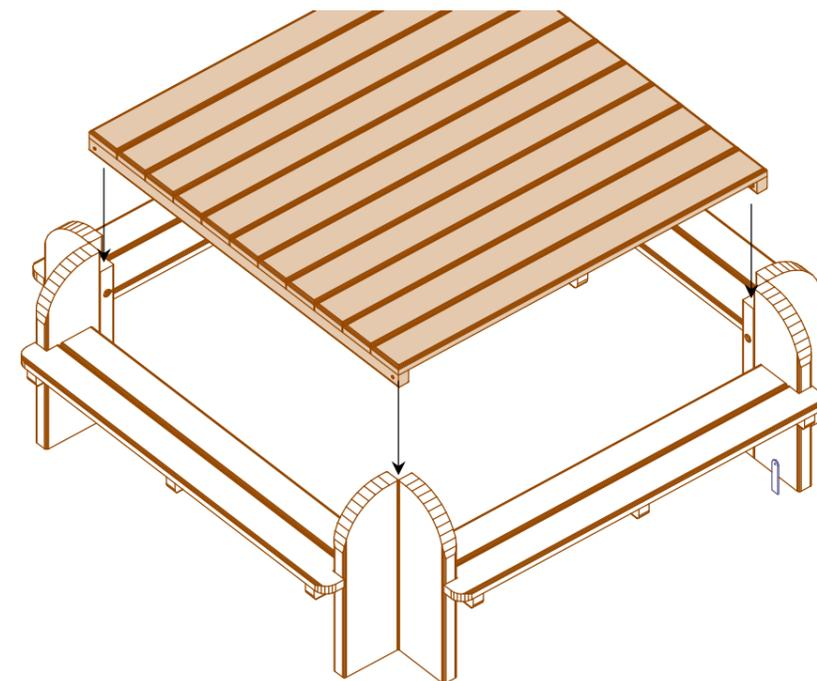
Positionner le plateau sur les 4 pieds et fixer celui-ci dans chaque angle à l'aide de tirefonds de 10x100 (T1). Fixer au sol la table à l'aide de pattes à scellement et tirefonds (T3) 6x45 + rondelles.
