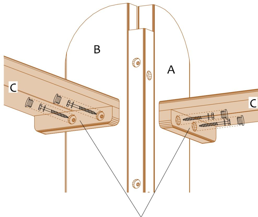
principe fixation éléments C
