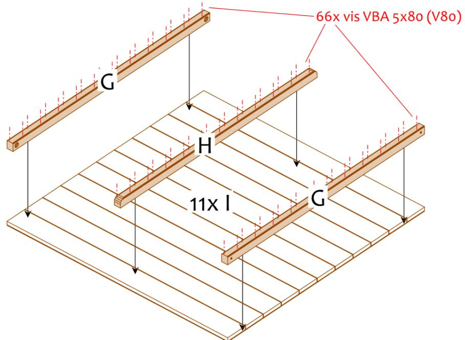
Assemblage au sol du plateau constitué de lames (I) à l'aide de traverses (G) pour les 2 extrémités et 1 traverse (H) en position centrale à l'aide de vis 8x80.
