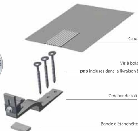
Le crochet de toit Rapid<sup>2+</sup> Slate a été spécialement conçu pour la fixation sur des toitures avec couverture en bardeaux sur une sous-construction de lattes et des chevrons étroits. La section découpée nécessaire pour la connexion du crochet de toit est couverte par la plaque de couverture (Slate). De plus, une bande d'étanchéité située entre le crochet de toit et le bardeau protège d'eau montante.
