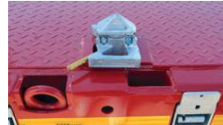
Boîtiers pour ranchers env. 100 x 50mm encastrées dans le cadre extérieur du plateau de chargement.
