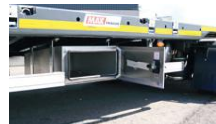
Caisse à outils INOX droite 565 x 290 x 810mm.
