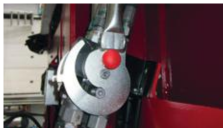
Raccords hydrauliques du plateau surbaissé au col de cygne par accouplement multiple au lieu accouplements à visser. Sans garantie sur les joints.
