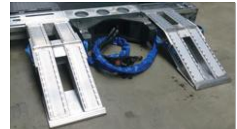
Rampes Alu VFR 120 pour passer au-dessus des crochets du plateau extra-surbaissé.
