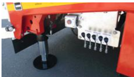
Béquilles hydrauliques à l'arrière.
