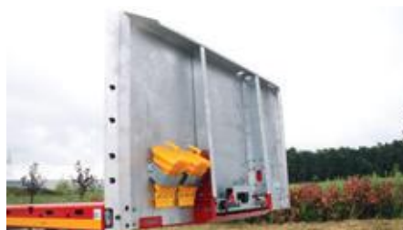
Une paroi avant, galvanisée, d'une hauteur d'env. 1.200mm.
