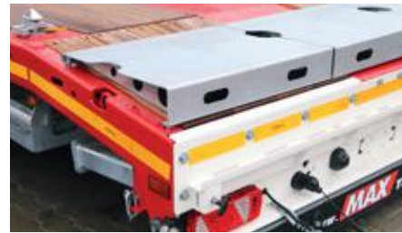
Cales de compensation galvanisées pour chanfrein 1.000 x 8° avec broches de fixation.
