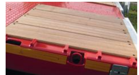
Fers carrés 20 x 20mm tous les 200mm sur le chanfrein du cadre extérieur du plateau de chargement.
