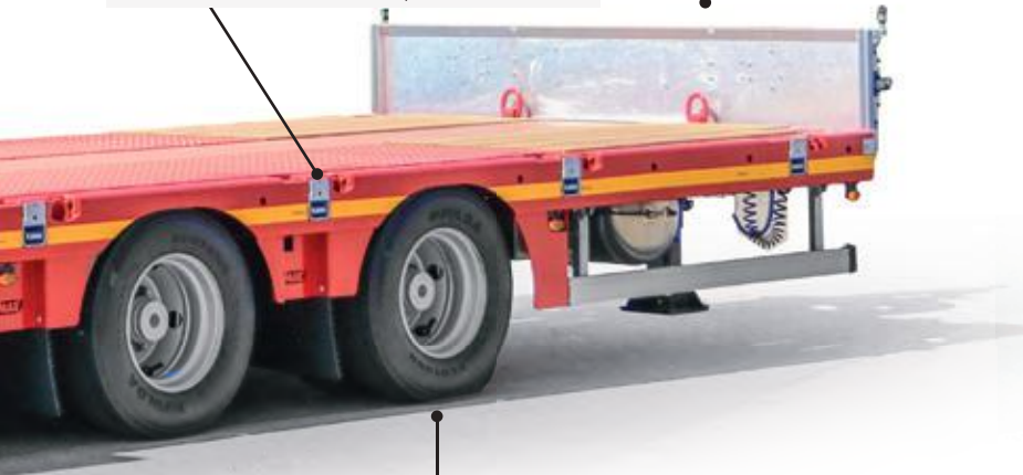
Premier essieu relevable (dépendamment de la charge) avec coussins d'air pour lever l'essieu.
