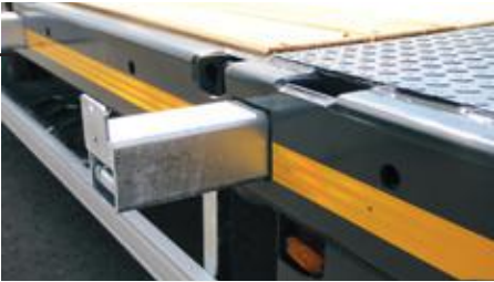
Elargisseurs galvanisés, extensibles d'env. 230mm par côté.
