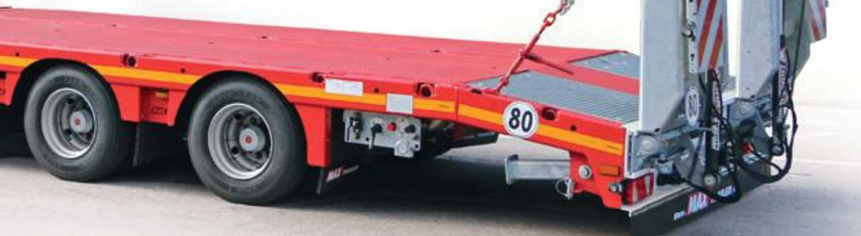
Un support galvanisé pour le plateau de chargement à la même hauteur que le col de cygne.
