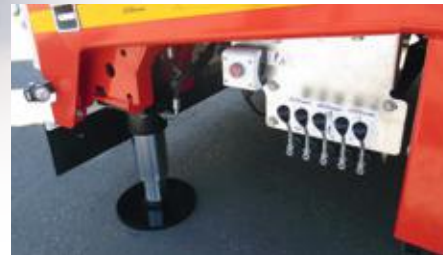
Béquilles hydrauliques à l'arrière.
