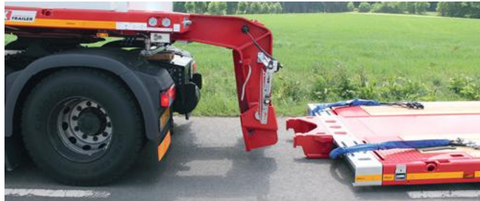
Rampes en acier pour passer au-dessus des crochets du plateau extra-surbaissé.
