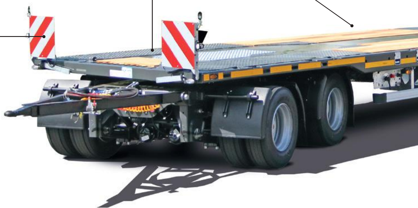
Pochettes conteneurs intégrées dans le plateau, pour des conteneurs 1 x 20".
