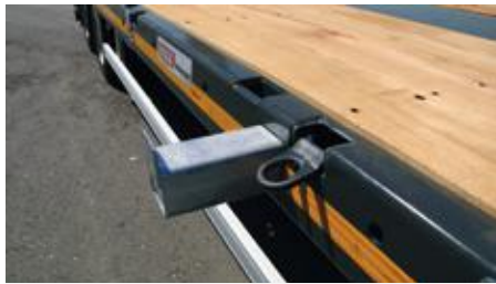
Elargisseurs galvanisés, extensibles d'env. 230mm par côté.
