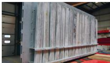
Rangement pour ranchers vissé à l'intérieur de la paroi avant.
