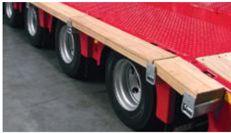
Elargisseurs galvanisés, extensibles d'env. 230mm par côté. Bastaings d'élargissement en bois dur.
