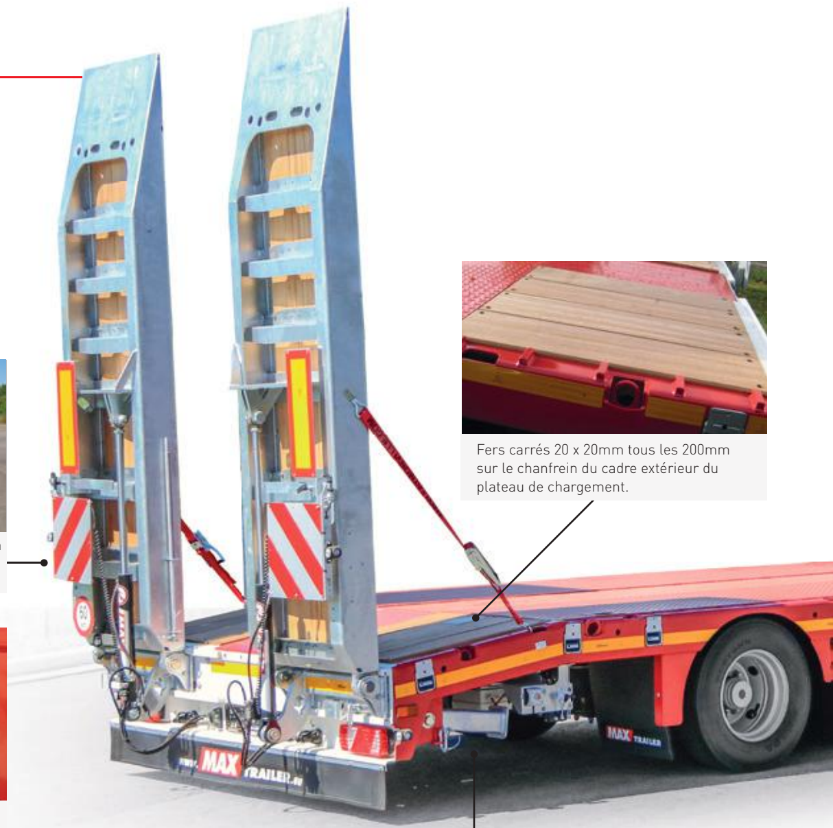
Panneaux de signalisation env. 423 x 423mm extensibles de \pm 400 mm avec 1 feu de position LED.
