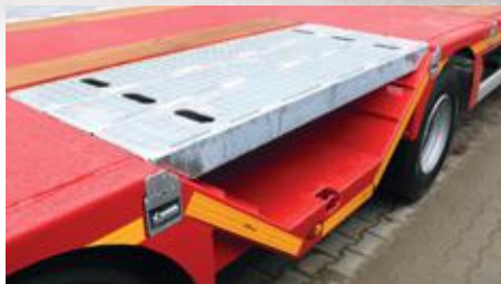
Recouvrement de fosse à roues.
