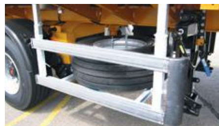
Support pour roue de réserve en-dessous du plateau de chargement.
