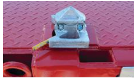
Pochettes conteneur WADER dans le plateau de chargement pour un conteneur 20". Fixations conteneurs WADER.
