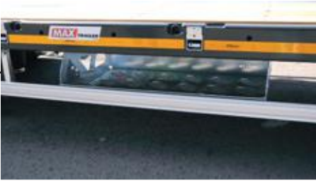
Un support galvanisé pour les bastinges d'élargissement en dessous du plateau de chargement .
