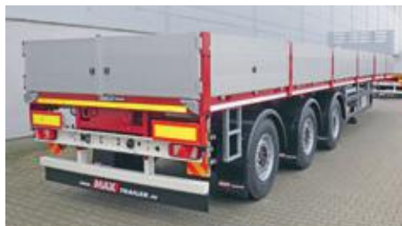
Ridelles rabattables en ALU, hauteur \pm 900mm, avec ranchers rabattables KINNEGRIP.
