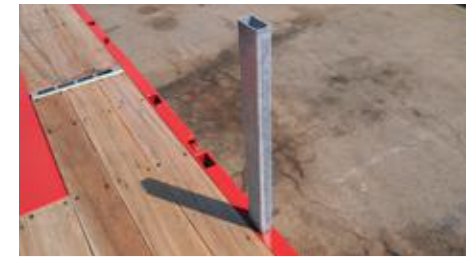
Boîtiers pour ranchers env. 100 x 50mm encastrés dans le cadre extérieur du plateau de chargement. Ranchers galvanisés env. 100 x 50mm, d'une hauteur 1.000mm.
