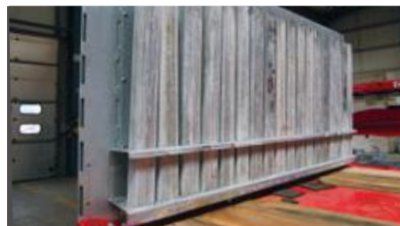
Rangement pour des ranchers vissé à l'intérieur de la paroi avant.
