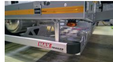
Un bac de rangement galvanisé en dessous du plateau de chargement. (2.410 x 1.025).
