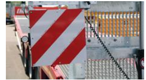
Au col de cygne et sur les rampes, à gauche et à droite, une fixation pour panneau de signalisation, inclus une prise.
