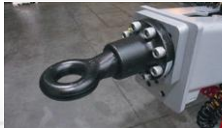
Timon de +/- 1.750mm de long, avec oeillet (50mm, 57mm ou 68mm diamètre).
