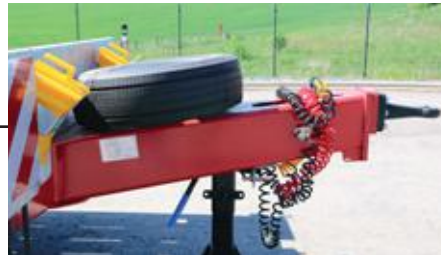
Timon de +/- 1.750mm de long, avec oeillet (50mm, 57mm ou 68mm diamètre).
