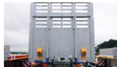
Une paroi avant, galvanisée, d'une hauteur d'env. 2.200mm.
