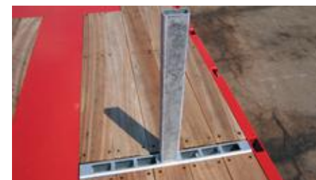
Rangées de boîtiers, installées dans le plateau de chargement.
