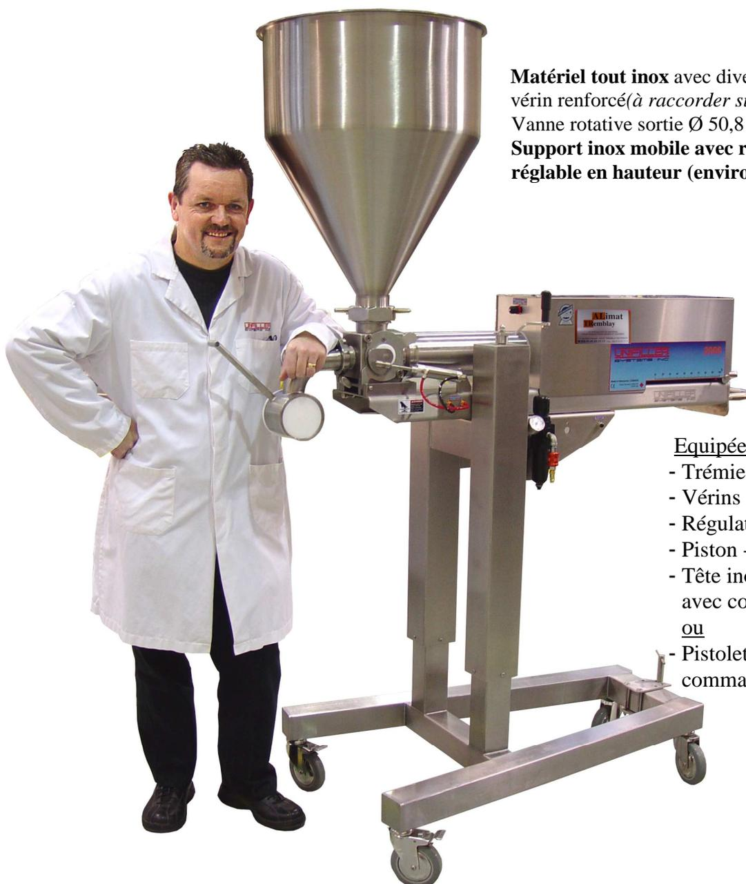
**Matériel tout inox** avec diverses commandes pneumatiques, vérin renforcé(à raccorder sur réseau d'air)
