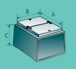
Il s'agit de démagnétiser d'une manière intermittente. Ils ne peuvent pas être branchés plus de 10 minutes. Ils ont un thermostat incorporé qui les débranche quand ils arrivent à la température maximale préconisée.
